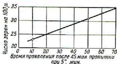
Рис. 6. Зависимость плотности зерен в следах частиц минимальной ионизирующей способности от длительности проявления.
