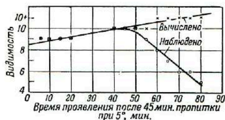
Рис. 7. Вычисленная и наблюдаемая видимость для различной длительности проявления после пропитки при 5^{\circ} в течение 45 мин.
