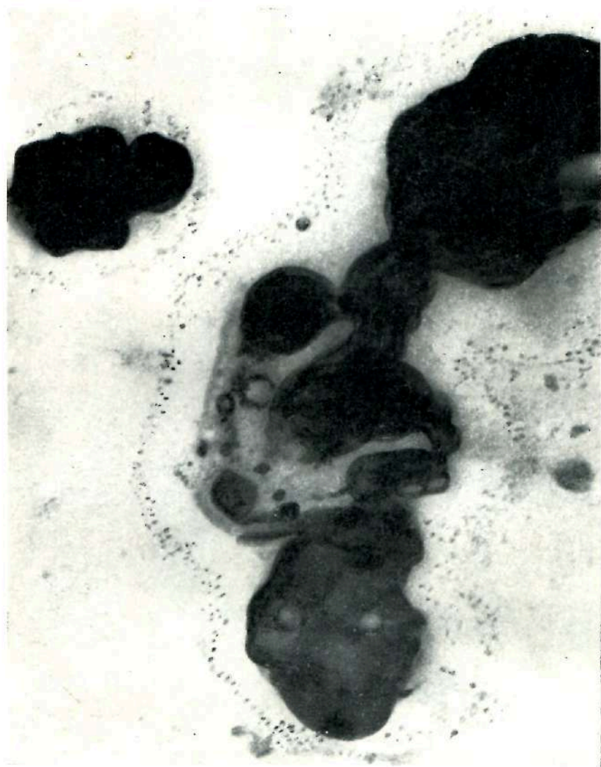
Рис. 3. Кристалл бромида серебра из высокочувствительной негативной эмульсии после продолжительной бомбардировки электронным пучком. Классический снимок: отчетливо видны очертания кристалла (46500X).
