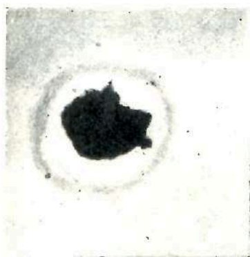
Рис. 6. Тонкий кристалл (100 Å) из эмульсии Ильфорд Q после кратковременного облучения электронами.
