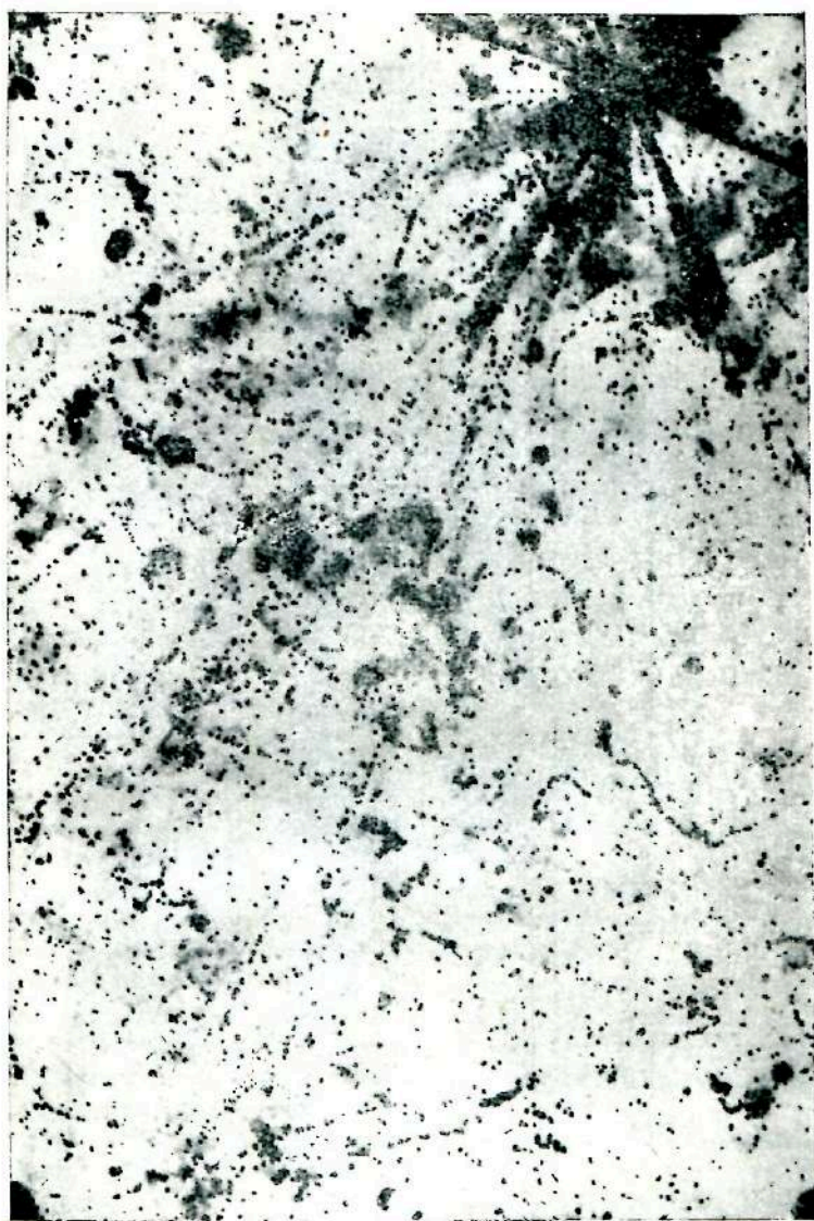
Р и с. 11. Звезда с 31 лучом; пластинка Кодак NT4 со слоем 400 \mu . Снимок произведен при одной фокусировке при помощи сухого объектива 40 \times (Козинс, Дилворс, Шенберг, Оккиаллини и Вермезен).
