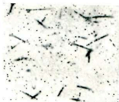
Рис. 6. Осколочные следы, проявленные раствором 7, который совершенно не способен проявлять следы \alpha -частиц.
