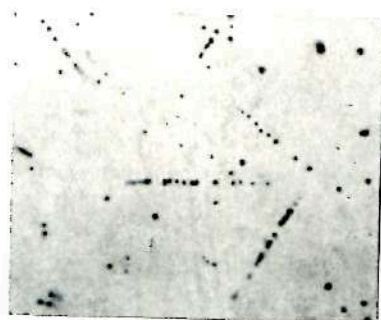
Рис. 4. Ослабленные \alpha -следы, проявленные раствором 4 в течение 40 мин.
